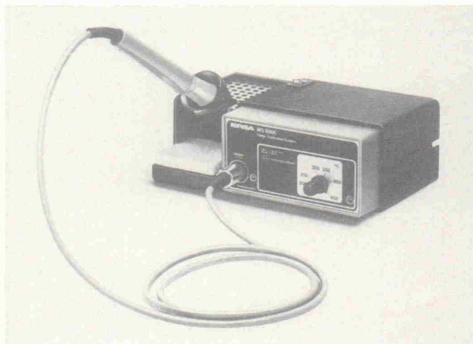
Die elektronisch temperaturgeregelte Lötstation MS 6000 von Ersä hat einen Regelbereich von 150 bis 450 °C. Die Ist-Temperatur wird über den temperaturabhängigen Widerstand des Heizkörpers erfaßt, mit der eingestellten Solltemperatur verglichen und über eine Triacschaltung nachgeregelt (Foto: Ersä).
