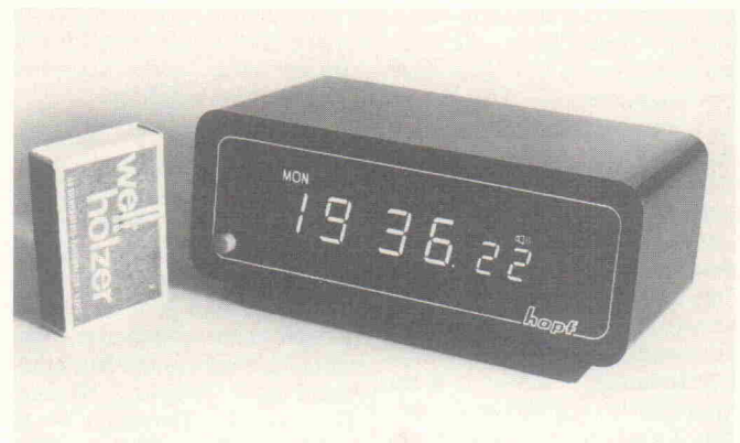
Als erste Funkuhr mit maskenprogrammiertem Mikroprozessor verfügt das Modell 4003 über eine eingebaute Quarzuhr zur Überbrückung von Sender- oder Empfangsstörungen (Foto: Hopf).
