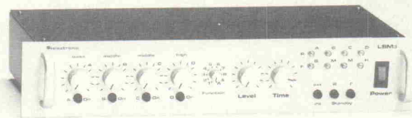
Das Profi-Steuergerät LSM 3 von dlc ist zugleich Lichtorgel und 4-Kanal-Lauflicht mit 8 Programmen und mehreren Ansteuermöglichkeiten, z.B. Musikimpuls (Foto: dlc).
